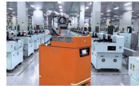
Die Bonder Loading & Unloading
